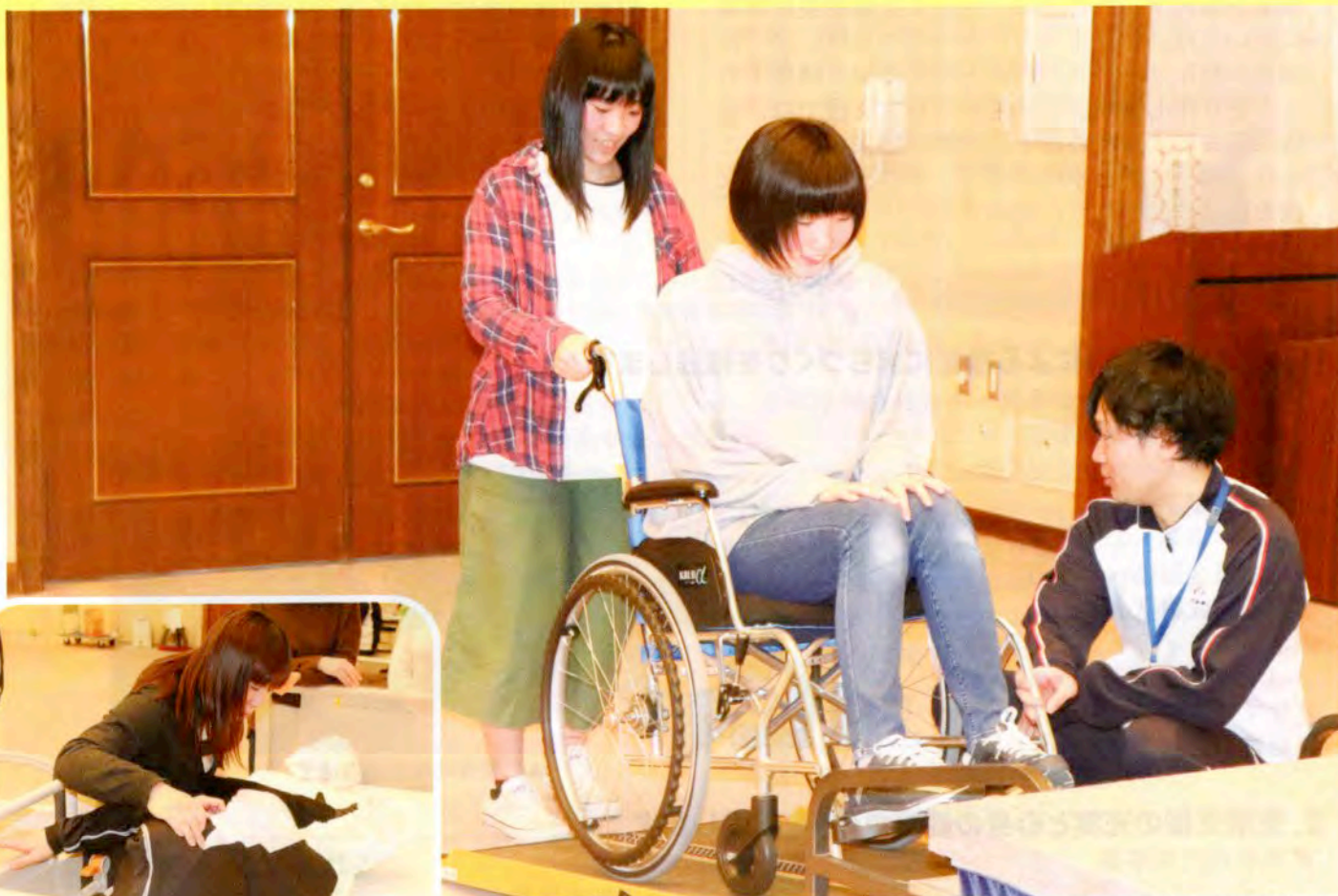
▲段差を越える時は「ティッピングレバー」を踏んで前輪を浮かせます。
